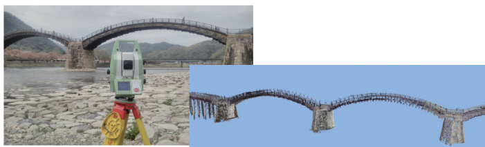
▲図4 左：3Dスキャニングの様子、右：錦帯橋の点群データ
